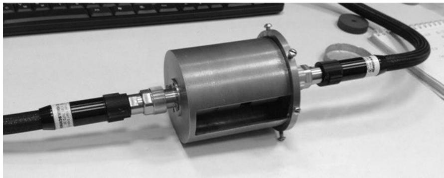
Рис.2. Подключение ячейки к векторному анализатору цепей
